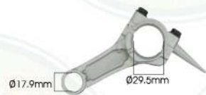
KM2500-32 Connecting rod ก้านสูบ
